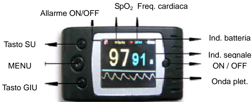
Figura 1 – descrizione funzioni del pannello comandi
